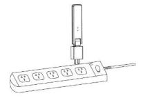
Hinweis: Installiere die DTU nicht direkt über Metall oder Beton, um Signalschwächung zu vermeiden.
